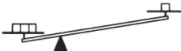
4.3 Máquina simple para levantar pesos.
